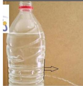
Todo cuerpo sumergido en un fluido sufre una presión sobre toda su superficie exterior, debida al propio peso del mismo. A esta presión se la conoce como presión hidrostática.
