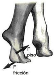
El rozamiento por fricción es una fuerza que aparece cuando intentamos deslizar un objeto sobre otro. Esta fuerza depende de las superficies en contacto. El coeficiente de rozamiento nos da una idea de lo rugoso que es un material. El coeficiente de rozamiento de la carretera disminuye en días de lluvia, y es aún menor si hay hielo.
