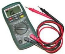
Para medir la intensidad de corriente se utiliza el amperímetro. Hay que conectarlo en serie, ya que si lo conectáramos en paralelo, la intensidad daría un valor distinto al real.
