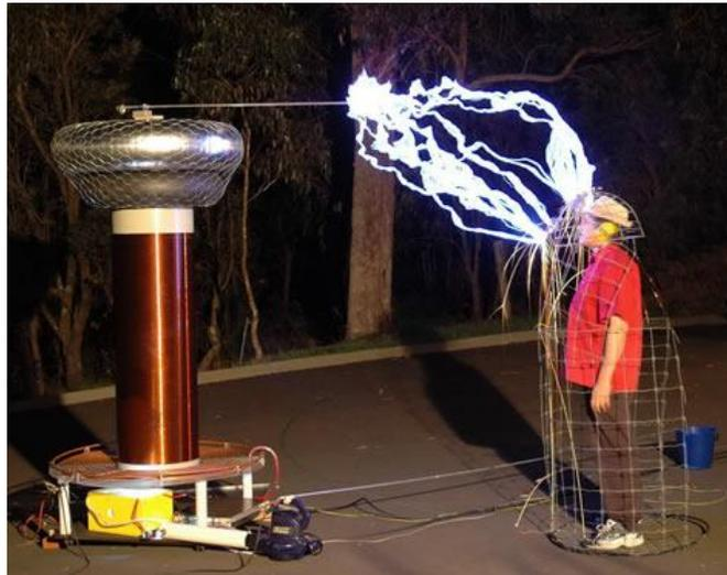
Esta propiedad se utiliza en los blindajes electrostáticos. Se rodean los aparatos que se desea proteger de la acción de las cargas eléctricas con una caja metálica o una tela metálica.
