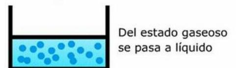
**Licuefacción de un gas (condensación):** Si las partículas de un gas llegan a estar suficientemente cerca, interaccionan entre sí, atrayéndose entre ellas, de manera que el gas pasa a estado líquido. Una manera de hacerlo es aumentar mucho la presión, como sucede cuando licuamos gas butano en las bombonas.
