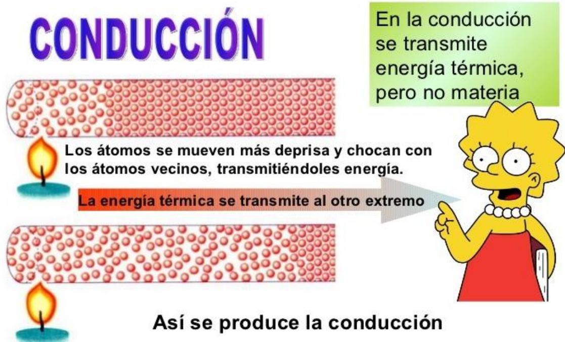
La sensación de frío o de calor está relacionada con la energía que sale o entra en nuestro cuerpo. No sólo depende de la temperatura del cuerpo que toquemos, sino también de si ese cuerpo es un buen o mal conductor (por ejemplo, un metal suele parecerse más frío).
