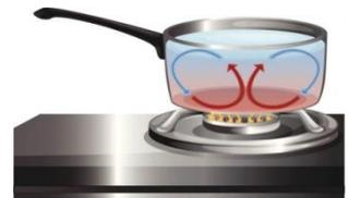
Cuando calentamos agua en un recipiente, éste empieza a calentarse por la parte inferior, y el agua que está en contacto con el mismo se dilata y se vuelve menos densa. El agua caliente asciende y transporta calor de la parte inferior a la superior. El agua de la parte superior, que está más fría, es más densa, desciende, se calienta y vuelve a subir. Este proceso genera el movimiento del agua.
